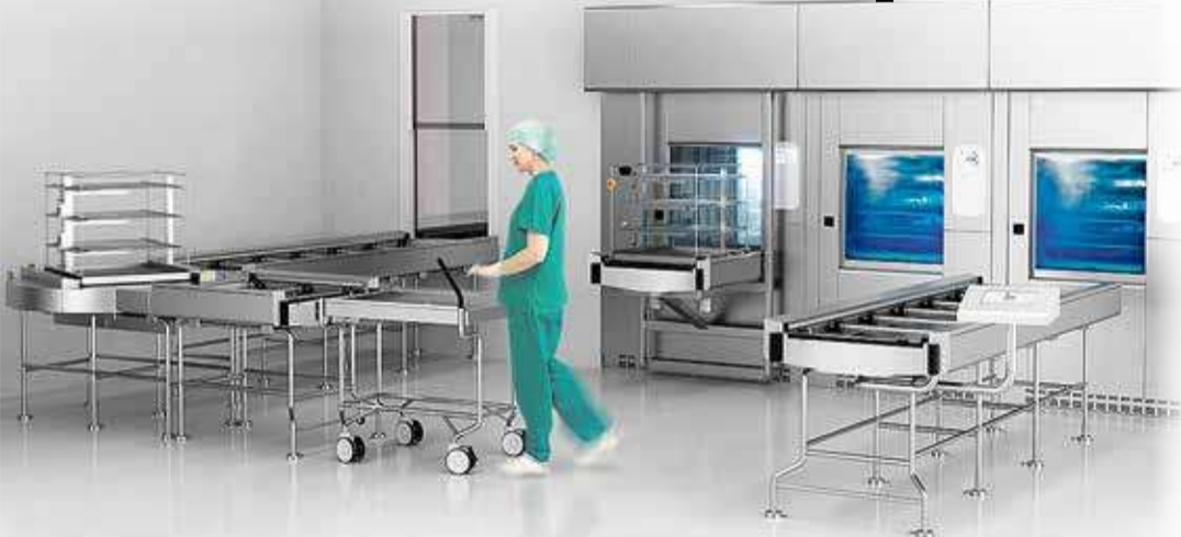
Metecis valmistatud sisseade meditsiinarvivate steriliseerimiseks.
