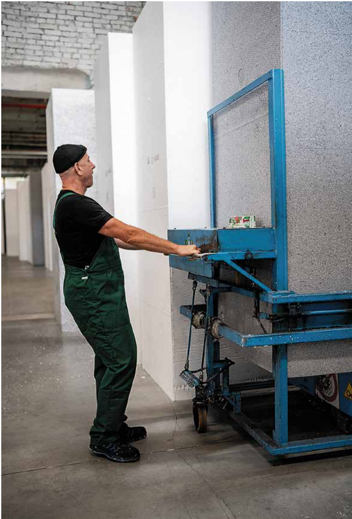
Vormist tulev kandiline plokk on pooltoode, millest lõigatakse vastava mõõduga soojustusplaadid.
