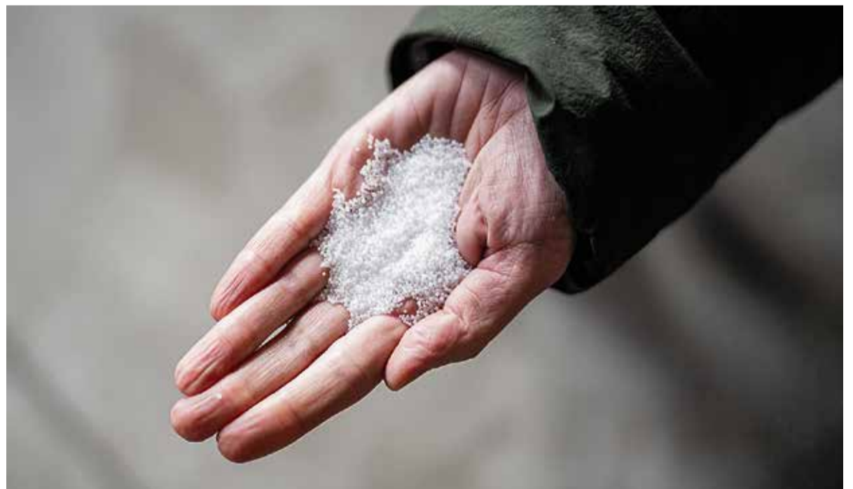
Soojustusplaadi tooraine näeb välja nagu peensuhkur.
